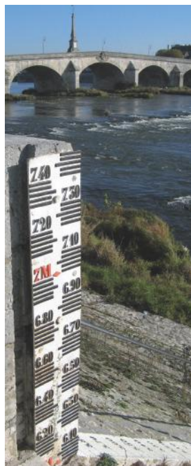
Fig. 8. Échelle hydrométrique principale de référence pour la Loire à Blois, rive droite, levée du quai de la Saussaye. Le niveau zéro est ici à altitude 65,94 m. Ce niveau zéro est propre à chaque échelle. Historiquement le niveau zéro des échelles de référence correspondait au niveau des plus basses eaux du lieu. Aujourd'hui, ce niveau est légèrement inférieur au repère indiqué (hauteur négative à l'étiage) par suite de l'évolution du lit du fleuve, liée notamment aux extractions de granulats.
