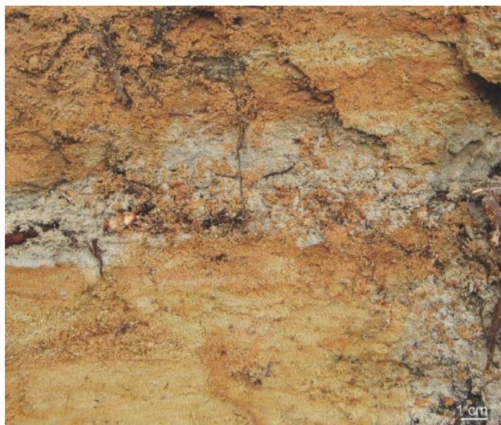
Fig. 6. Sables et argiles de Sologne : la roche, ici des sables (grains de moins de 2 mm, constitués pour 75 % de quartz et 25 % de feldspaths) et des silts (grains entre 0,4 et 0,6 mm, constitués de quartz). Sables et silts sont enrobés dans une matrice argileuse. L'état d'oxydation du fer donne des teintes variées. Dans certains endroits de la carrière, un litage oblique*, indicateur de courants, est observable.
